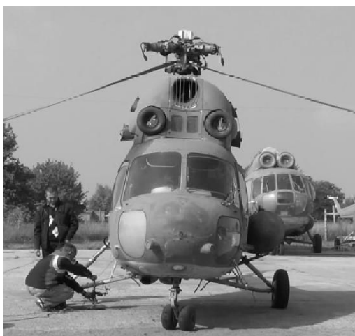
Рис. 3 – Натурные испытания по определению собственной частоты колебаний
