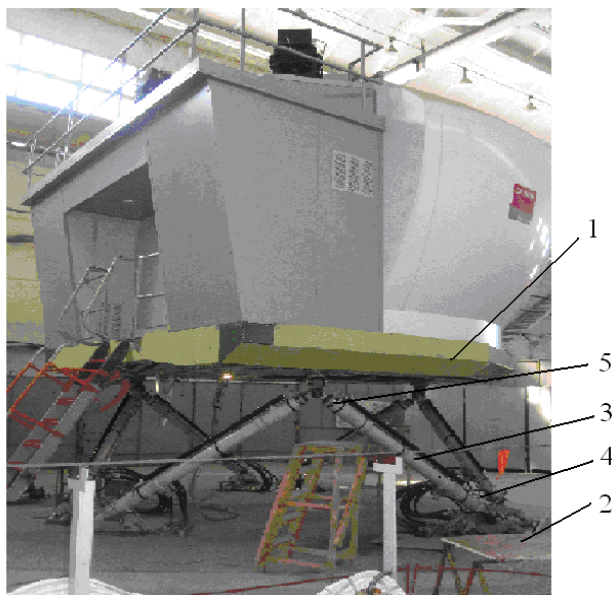
Рис. 1 – Тренажер-гексапод екіпажу мобільної техніки
